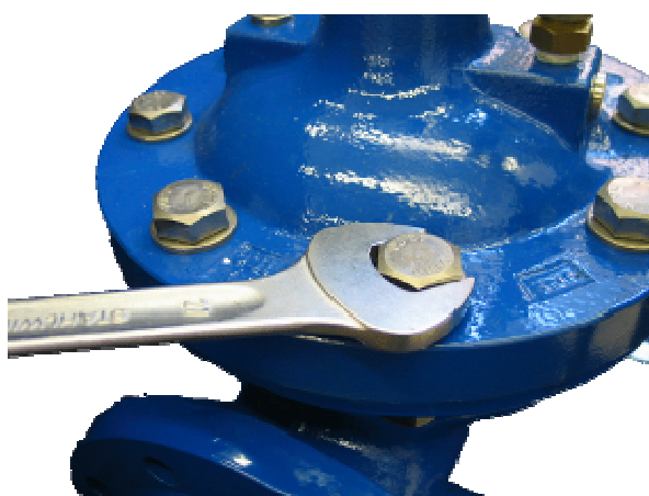
Obrázek 4.2 – Závitové spojení (šroubový spoj) víko – těleso
